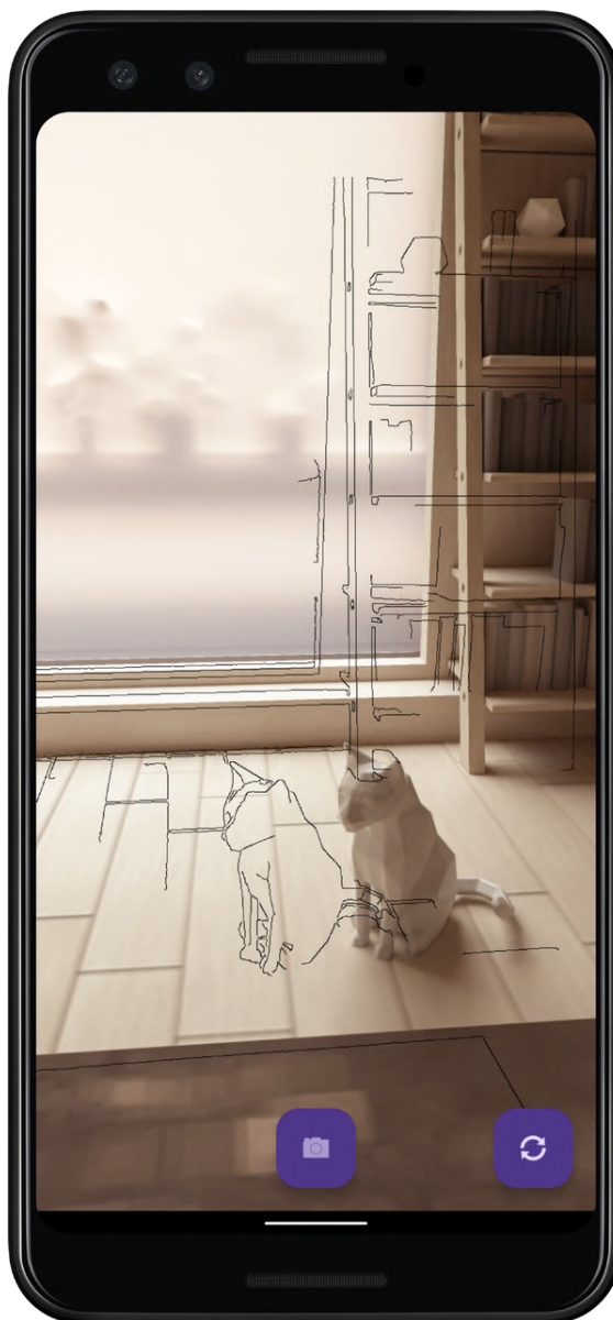
Obrázek 6.6: Navigace pomocí hran místo barevného obrázku. Hrany byly detekovány pomocí Cannyho hranového detektoru.
