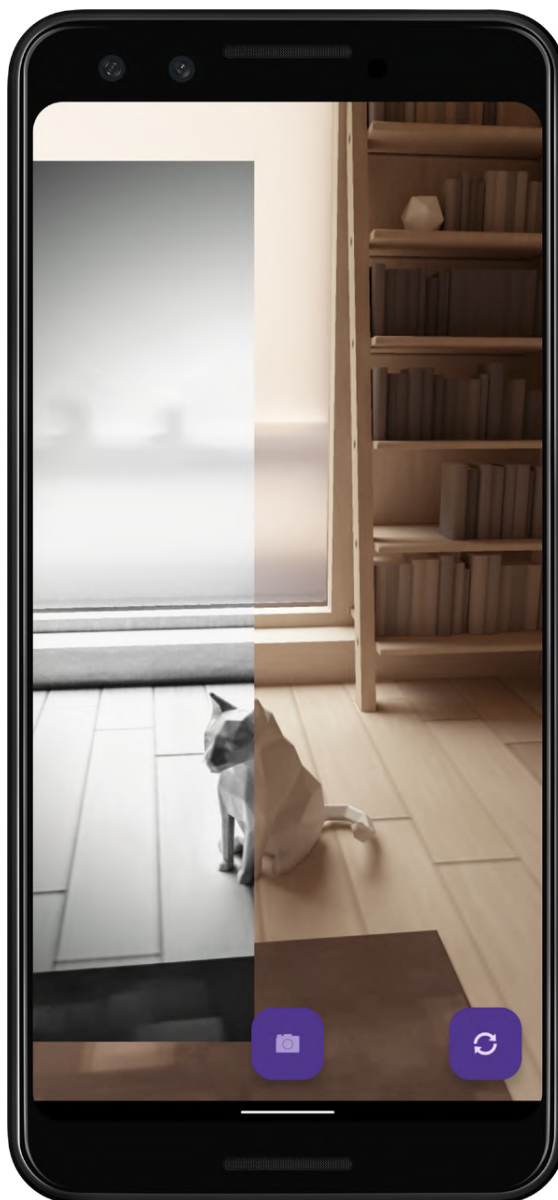
Obrázek 6.5: Překryv náhledu kamery původní fotografií. Na snímku obrazovky je pak průhlednost původní fotografie nastavena na 100 % a ořez na 45 %.
