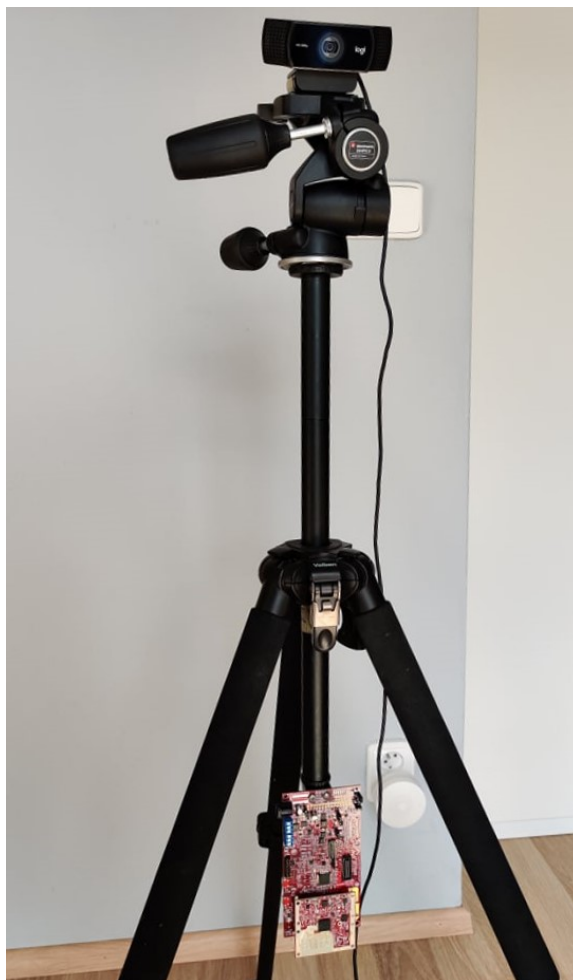
Obrázek 4.4: Umístění senzorů na stativu – verze 2
