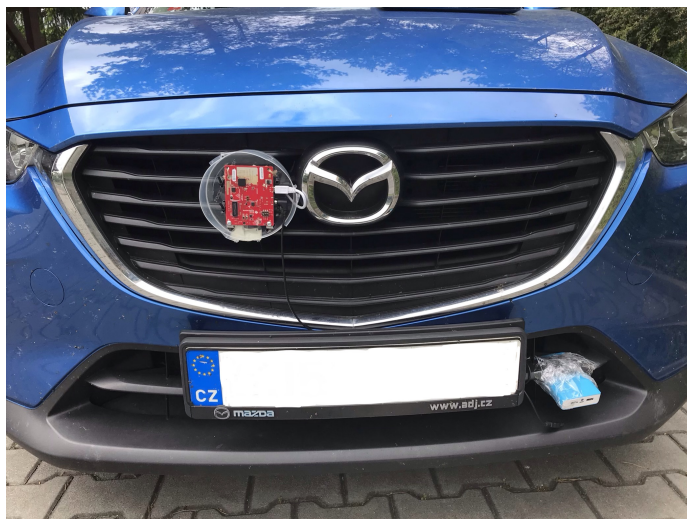
Obrázek 7.1: Fotografie upevnění radarového modulu a zdroje napájení na masku vozidla při sběru dat.
