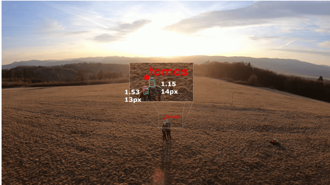
Obr. 5.5: Video snímané v rozlíšení 2,7K. Na zázname sa nachádzajú 2 osoby, ktoré sú aj v databáze tvárí. Jedna osoba nie je rozpoznaná, pretože vzdialenosť k najbližšej tvári v databáze je 1,53. To je spôsobené tým, že táto osoba má na zázname slnečné okuliare a čiapku. Druhá osoba je rozpoznaná správne. Šírka tváří je 13 a 14 pixelov. Vzdialenosť drona od osôb je asi 12 metrov a výška snímania je asi 8 metrov.
