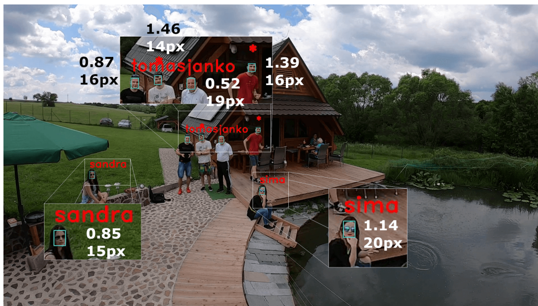
Obr. 5.4: Video snímané v rozlíšení Full HD. Dokopy sa na videu nachádza 7 osôb, z toho 2 osoby nie sú v databáze. Ich vzdialenosť od najbližšej tváre v databáze je 1,39 a 1,46, čo je vzdialenosť vyššia ako zvolený prah. Šírka tvárí sa pohybuje v rozmedzí 14 - 20 pixelov a známe tváre sú rozpoznané správne. Vzdialenosť drona od osôb je asi 9 metrov a výška snímania je zhruba 4 metre.
