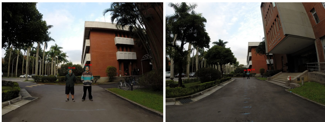
Obr. 4.2: Porovnanie maximálnej vzdialenosti pri úspešnej detekcii tvárí na datesete DroneFace. Vľavo je hlboká neurónová sieť z knižnice OpenCV (6 metrov), vpravo je detektor MTCNN (17 metrov).
