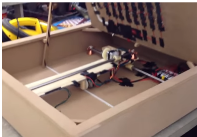
Obrázek 2.6: Šachovnice s automatickým pohybem dílků - ukázka vnitřního mechanismu pro pohyb dílků, převzato z https://www.youtube.com/watch?v=XCp4M08IWnA
