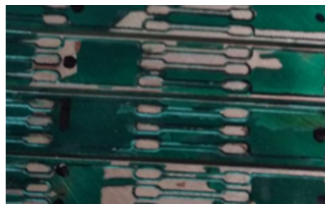
Obrázek 5.9: Jednotlivé kroky výroby plošného spoje z leva vyřezaná deska, deska před napájením komponent
