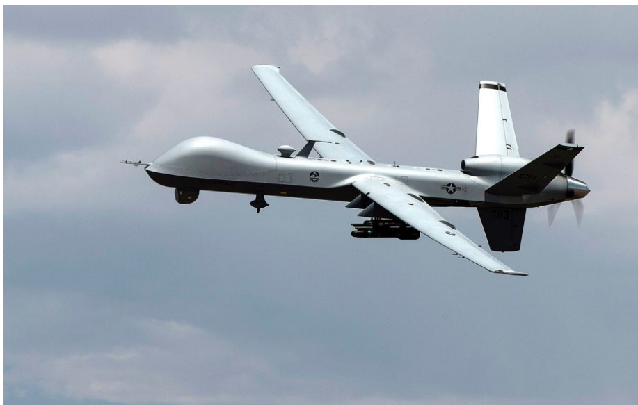
Obrázek 2.1: Dron s pevnou nosnou plochou MQ – Reaper využívaný U.S. Air Force. 1
