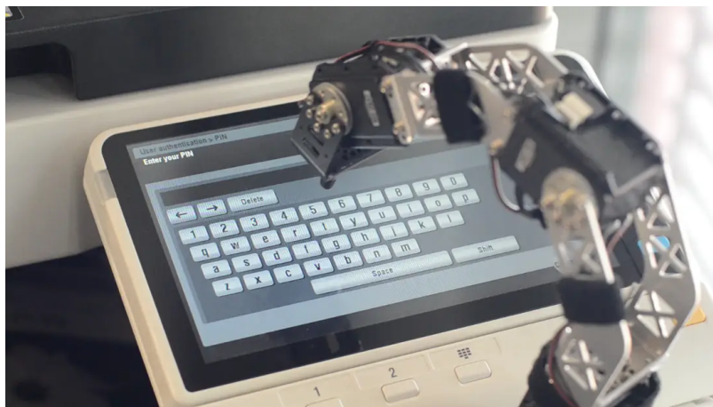
Obrázek 6.1: Robotické rameno využívané pro automatické testování vestavěných zařízení
