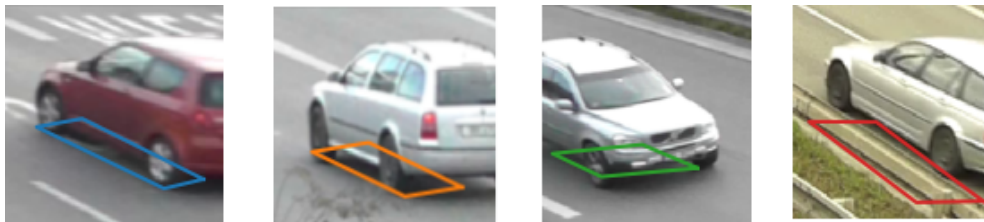
Obrázek 5.8: Ukázka chybné regrese při zpracování částí vozidel.
