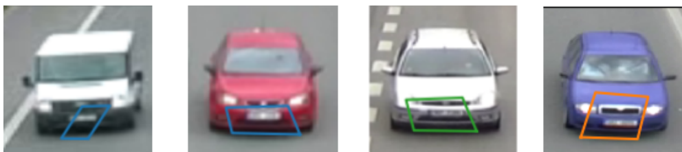
Obrázek 5.9: Ukázka chybné regrese při zpracování vozidel nasnímaných z přední strany.
