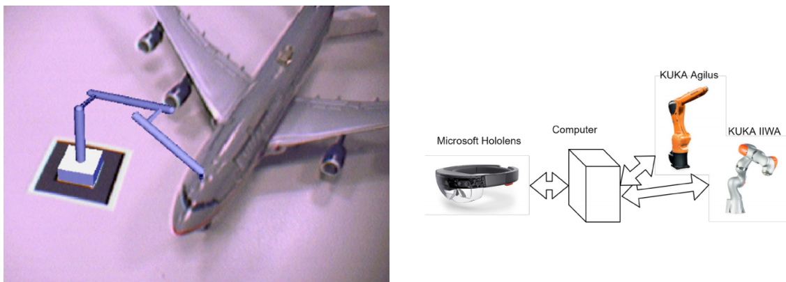
Obrázek 4.3: Obrázek vlevo zobrazuje miniaturu letadla s virtuálním robotem, převzato z [19]. Na obrázku vpravo je možné vidět možný systémový hardware pro AR v robotice. Převzato z [18].
