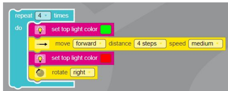
Obrázek 4.5: Ukázka tvorby vizuálního programu pomocí bloků v aplikaci OzoBlockly.
