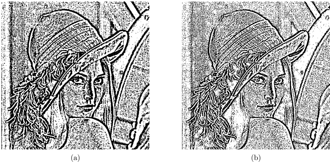
Obr. 5.4: (a) Algoritmus adaptívneho prahovania použitý na obrázok Lenny. (b) Adaptívne Gaussovo prahovanie. Rozdiel medzi týmito dvoma algoritmami je ten, že Gaussovo prahovanie využíva k výpočtu prahovej hodnoty okolie s hodnotami Gaussovskej funkcie.
