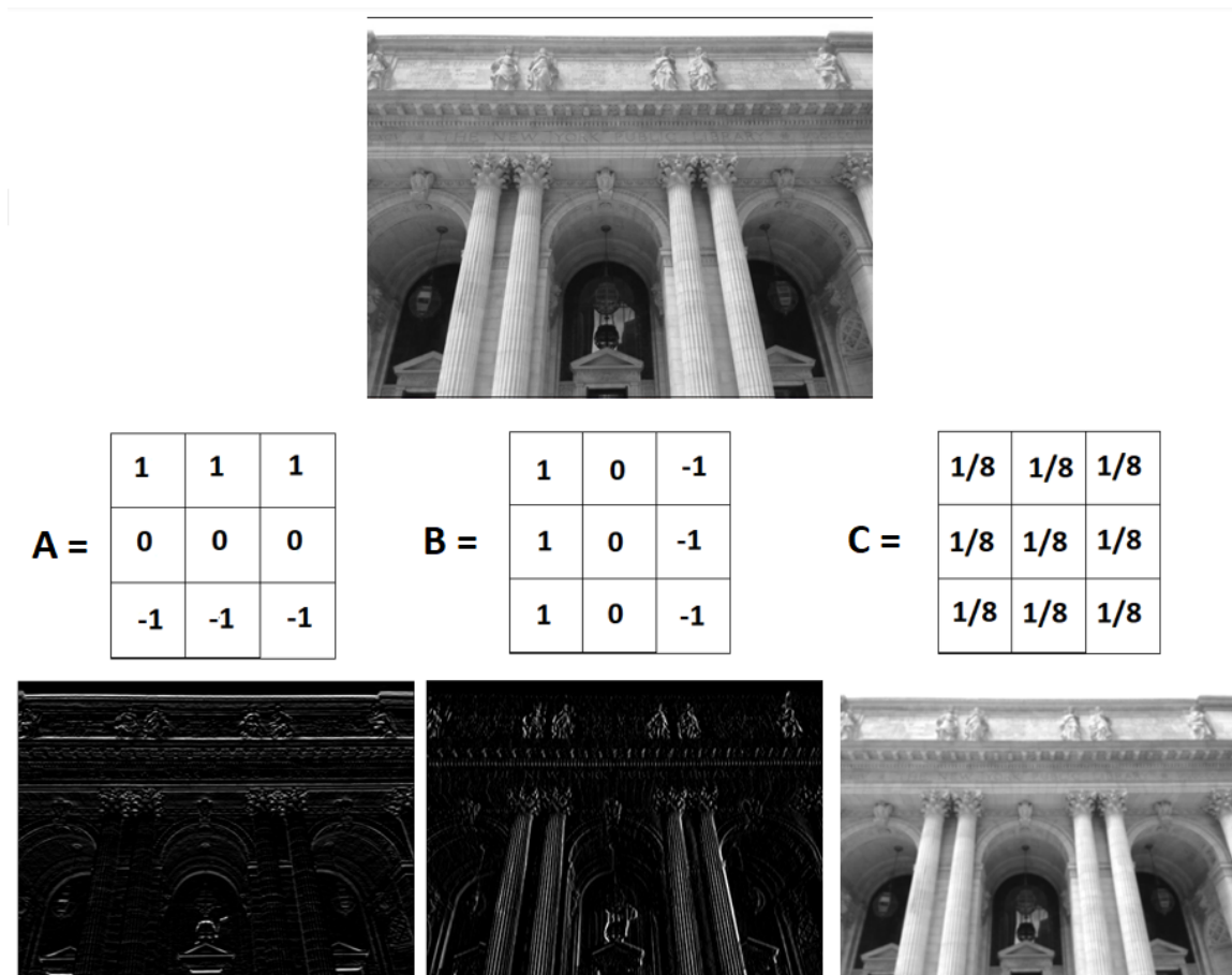
Obrázek 3.5: Ukázka aplikace Sobelových filtrů na obraz. Levý obraz je modifikací pomocí filtru na zachycení horizontálních hran, prostřední obraz je modifikován filtrem pro zachycení vertikálních hran a pravý obraz byl modifikován filtrem pro zahmlení ostrých frekvencí neboli rozostření obrazu.
