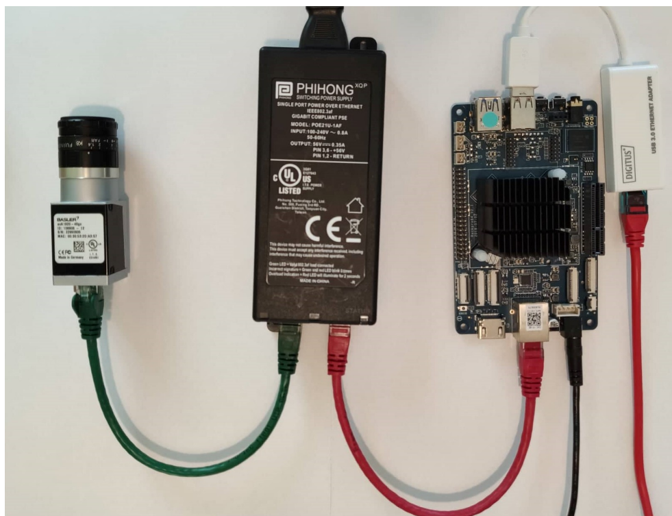
Obrázek 4.2: Fyzické zapojení všech hardwarových prvků serveru
