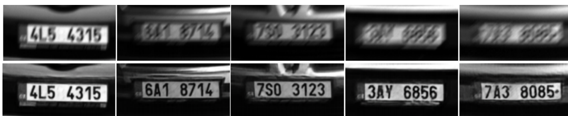
Obrázek 3.4: Výsledky rekonstrukce poznávacích značek. V prvním řádku jsou poznávací značky zachycené kamerovým systémem s prodlouženým časem expozice. Na druhém řádku jsou výstupy sítě CNN-L15 natrénované pro doostření rozmazání s délkou 1–23px. Obrázek a popis převzat z [32].
