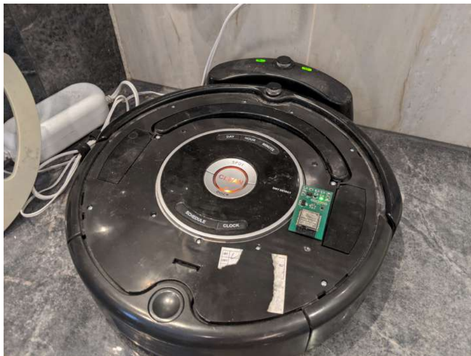
Obrázek 5.4: iRobot Roomba s nainstalovanou DPS.
