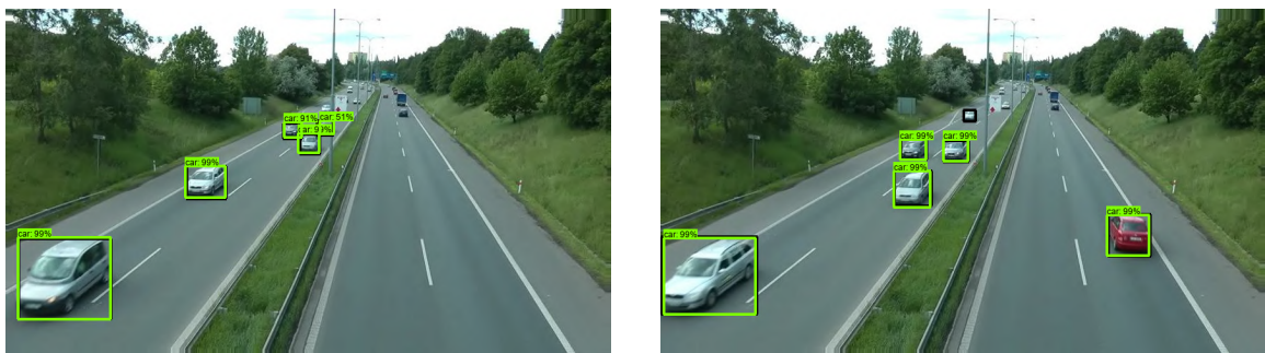
(a) Výsledek testovací sady na modelu Faster R-CNN, kde model detekoval všechny projíždějící vozidla.
