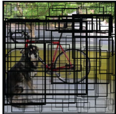
(b) Vstupní obrázek, s ohraničeními, kde tloušťka čáry odpovídá pravděpodobnosti, že se vevnitř nachází objekt. Čím tlustší čára, tím větší pravděpodobnost [10].
