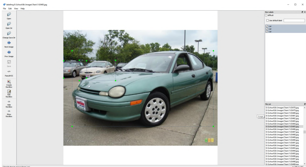
Obrázek 3.10: Anotací program labelImg, který byl využit k anotování vytvářeného datasetu.
