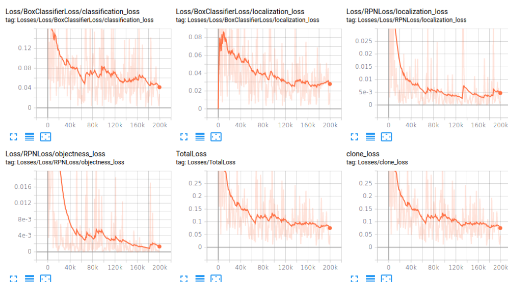
Obrázek 3.13: Průběh trénování modelu Faster R-CNN. Výsledky jsou vyhlazeny hodnotou 0.93.
