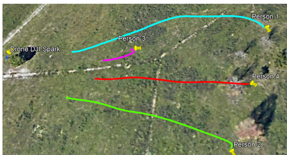
Obrázek 6.30: Ukázka výsledků na videozáznamu 2. Sever směrem k horní hraně obrázku. Byla použita předdefinovaná nastavení s DEM TDM90. Navíc byla změněna hodnota otočení dronu (yaw) o přírůstek 10^\circ , tedy směrem doprava, a hodnota náklonu (pitch) o -5^\circ , tedy směrem dolů.
