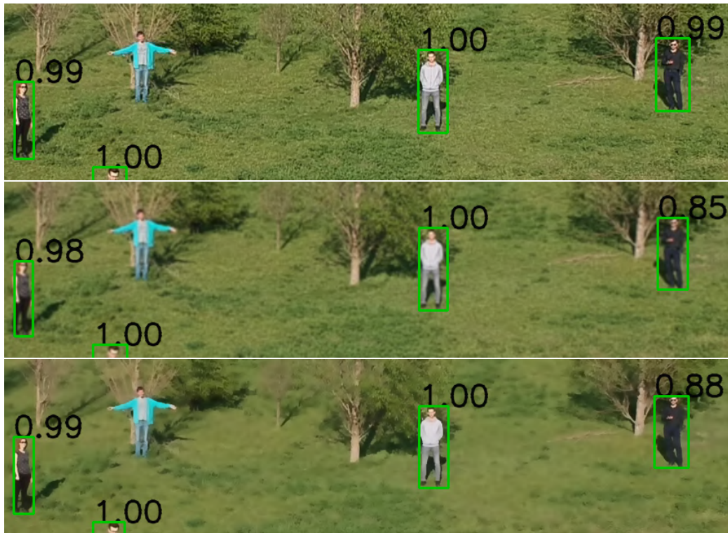
Obrázek 6.4: Porovnání úspěšnosti detekce v závislosti na použitých filtrech šumu. Uvedená čísla znamenají hladinu jistoty detekce označené osoby. Shora jdoucí části jsou: a) původní obraz, b) jemná varianta Gaussova rozmazání, c) výrazná verze bilaterálního filtru.
