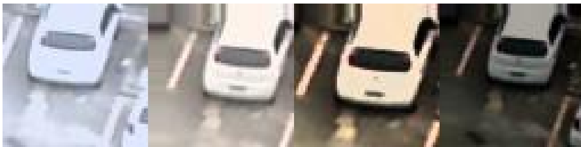
Obrázek 5.2: Augmentace snímku jednoho auta. Posouváním původního obrázku a jeho zvětšením, či zmenšením se simuluje nepřesnost detektoru. Úpravou vyvážení bílé a jasů jsou simulované různé světelné podmínky.
