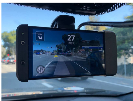
Obr. 2.3: Ukážka vývojovej súpravy comma two spoločnosti comma ai. Jedná sa o systém priamo pripojený k rozhraniu vozidla, využívajúci mobilný telefón ako kameru a výpočtovú platformu na detekciu cestných pruhov, prekážok a iných vozidiel. Prevzaté z [22].
