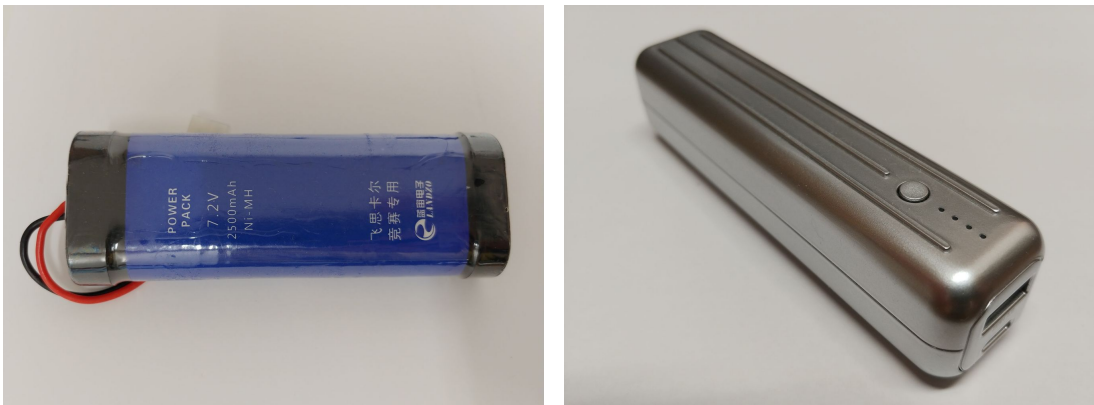
Obr. 3.4: Zľava originálny 2500 mAh Ni-MH akumulátor pre napájanie akčných členov a systémových dosiek. Vpravo Zendure SuperMini 5000 mAh určený pre napájanie platformy Raspberry Pi a sensorovej výbavy.
