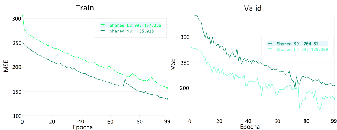
Obr. 5.9: Porovnanie priebehu loss funkcií počas tréovania modelu Shared s a bez L2 regularizácie.
