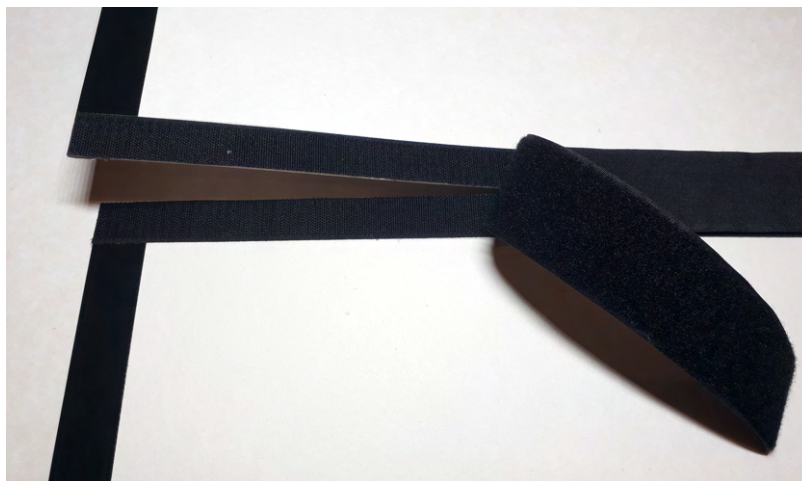
Obrázek 7.3: Pohled na spodní stranu dílů dráhy a detail jejich způsobu spojení suchým zipem v jeden celek (galerie autora).
