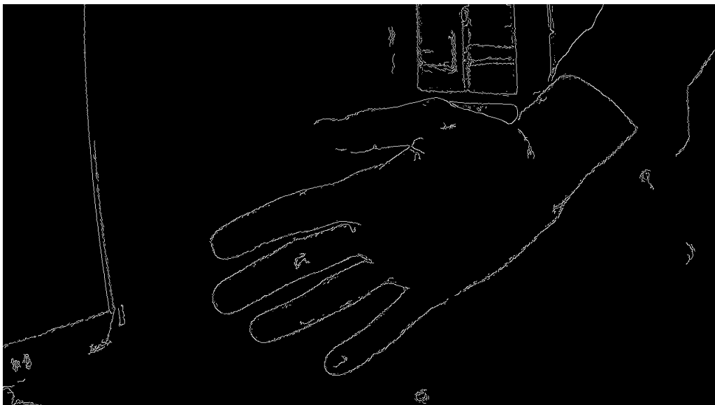
Obr. 3.9: Ukážka Cannyho detekcie hrán.
