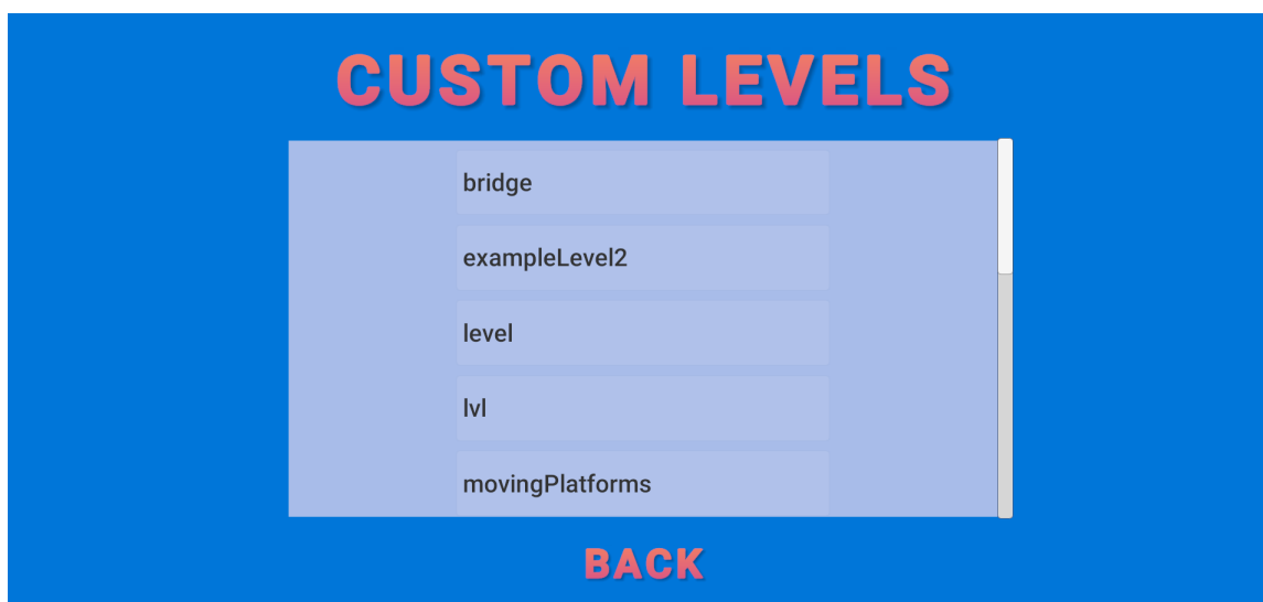
Obrázek 5.4: Screenshot z CustomLevelsMenu, kde se zobrazuje seznam hráčem vytvořených levelů, které je možné si zahrát. Menu je tvořené nadpisem (TMP - Text element), UI elementem ScrollView obsahujícím tlačítka, které načtou scénu Scoreboard (viz podsekcce 5.1), která obsahuje tabulku s časy pro daný level. Dále se zde nachází tlačítko Back, které načte scénu MainMenu.
