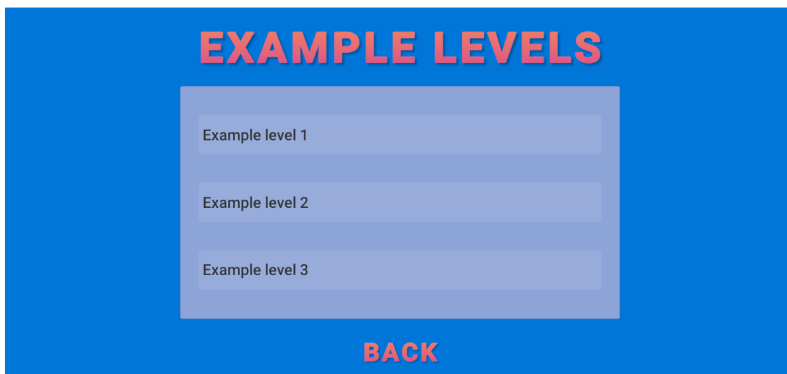
Obrázek 5.3: Screenshot z ExampleLevelsMenu, kde se zobrazují předvytvořené levely, které si hráč může zahrát. Menu je tvořené nadpisem (TMP - Text element), UI elementem ScrollView obsahujícím tlačítka, které načtou scénu Scoreboard (viz podsekcce 5.1), ve které je tabulka s časy pro daný level. Dále se zde nachází tlačítko Back, které deaktivuje objekt ExampleLevelsMenu a znovu aktivuje objekt MainMenu.
