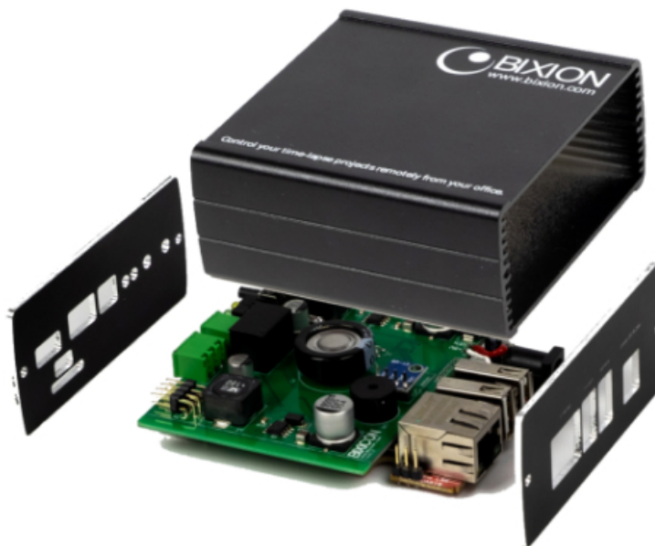
Obrázek 5.1: BixiCon intervalometr, převzato z webové stránky [3].
