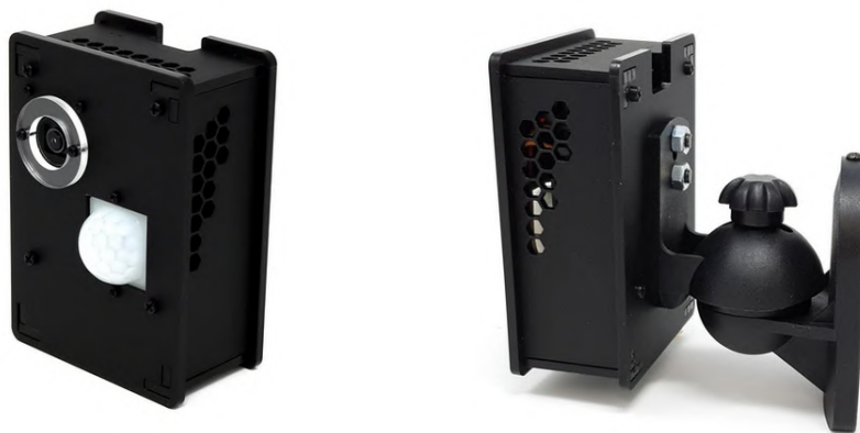
Obr. 3.10: Puzdro prispôsobené na použitie PIR a kamerového modulu, prevzaté z [5].
