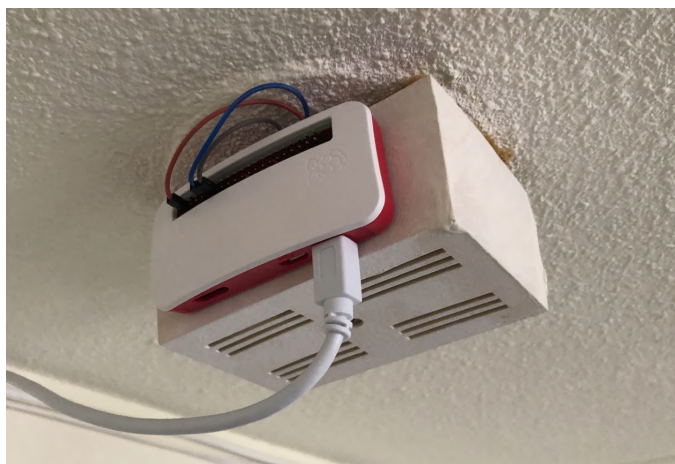
Obr. 2.2: Raspberry Pi Zero pripojený k obvodu domového zvončeka, prevzaté z repozitára.
