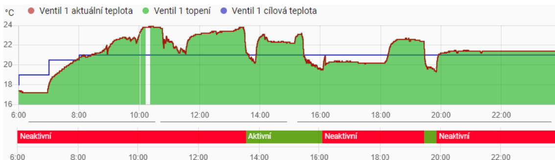
Obrázek 7.4: Graf testování ze dne 15.3. Červeně průběh aktuální teploty, zeleně požadované (cílové) teploty. Pod grafem je průběh detekce otevřeného okna, červená znamená okno zavřeno, zelená otevřeno (a v reakci na to vypnuté topení). Spodní graf vyjadřuje detekci otevřeného okna, červená znamená zavřeno, zelená otevřeno.
