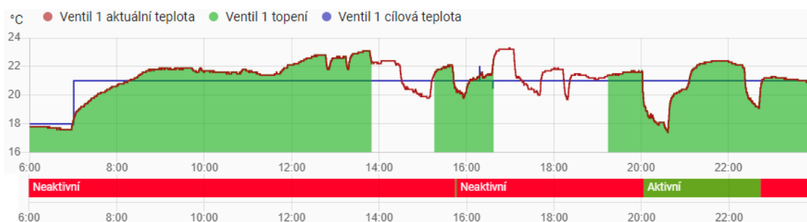
Obrázek 7.3: Graf testování ze dne 12.3. Mezi 20:02 a 22:43 bylo (chybně příliš dlouho) detekováno zavřené okno. Červeně průběh aktuální teploty, zeleně požadované (cílové) teploty. Spodní graf vyjadřuje detekci otevřeného okna, červená znamená zavřeno, zelená otevřeno.
