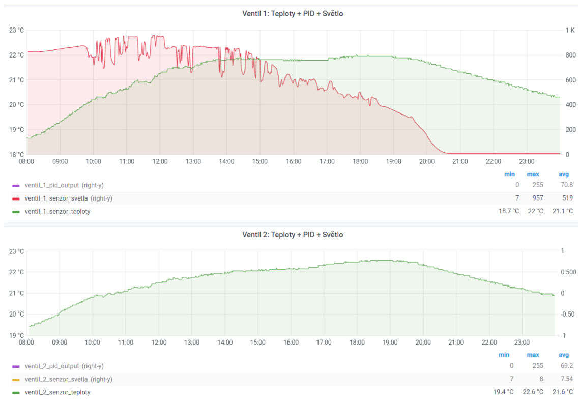
Obrázek 7.6: Grafy testování ze dne 8.5. s vypnutým centrálním termostatem. Zeleně teplota, červeně intenzita slunečního svitu (0 až 1023).
