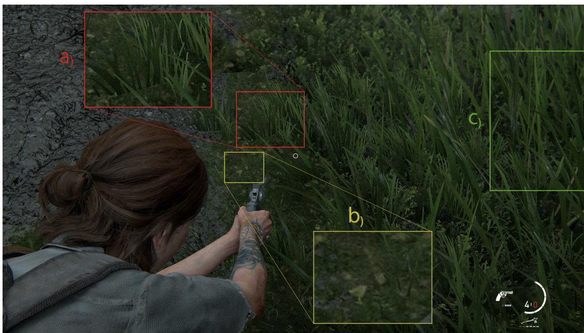
Obr. 2.26: Snímok obrazovky zachytený z hry The Last of Us Part II na konzole PS4 Pro. V tomto prípade je využitých niekoľko techník pre vykreslenie trávniku. a) 2D billboardy sú využité pri prechode medzi hustou časťou trávniku a terénom bez trávy. b) Terén pod trávou pokrýva trávová textúra. c) 3D geometria je využitá v časti, kde je tráva hustejšia a hráč s ňou môže interagovať.
