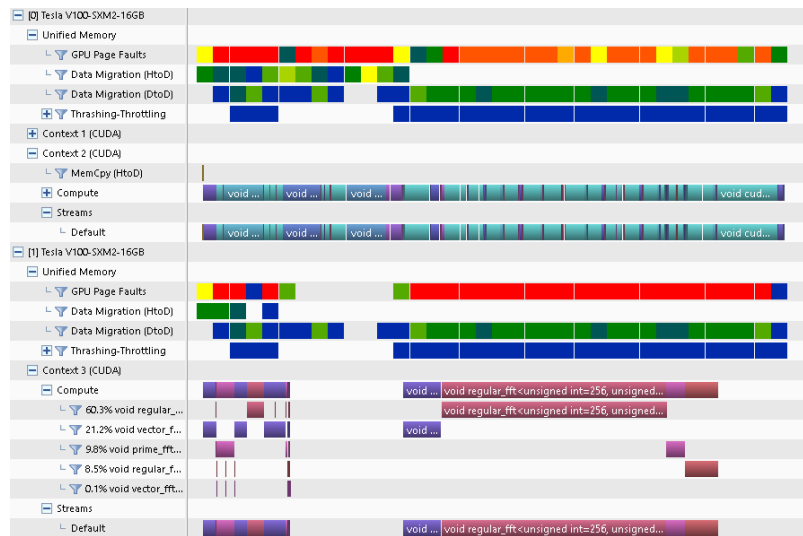
Obrázek 7.8: Výstup nvprof pro výpočet 256x256x256 matice na dvou GPU zobrazený v Nvidia Visual Profileru.
