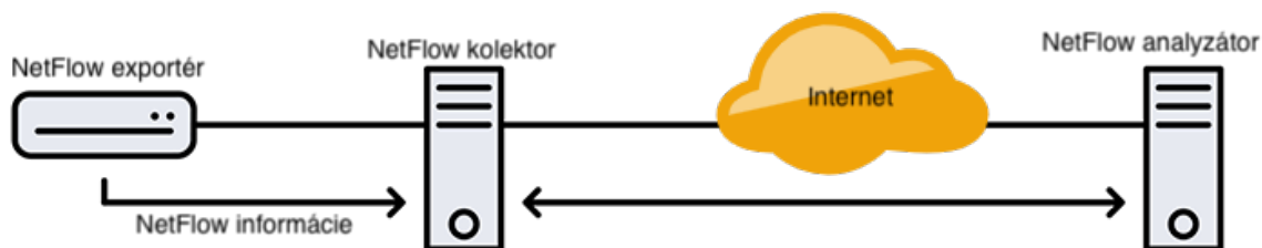
Obr. 2.2: Architektúra technológie NetFlow [28]
