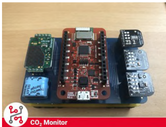
Obrázek 2.5: Měřič CO_2 postavený pomocí HARDWARIO TOWER IoT Kit. Foto autor
