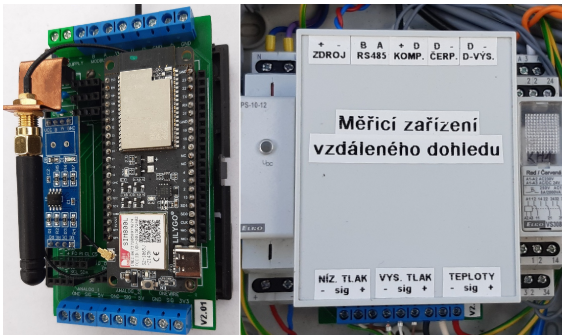
Obrázek 5.3: Výsledná podoba měřicího zařízení.
