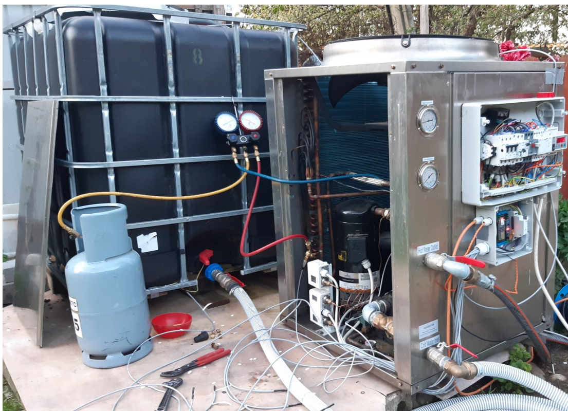
Obrázek 7.1: Proces nasazení měřicího zařízení na tepelné čerpadlo.
