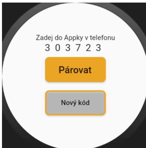
Obrázek 6.8: Párování hodinek s uživatelem v aplikaci na chytrých hodinkách. Aplikace vygeneruje kód, co je zadáný v aplikaci na telefonu. Po potvrzení dojde ke stažení uživatelských dat potřebných k přihlášení do hodinek.
