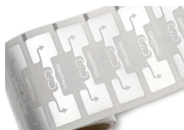
Obrázek 4.2: Jednorázový RFID pasivní čip [1].
