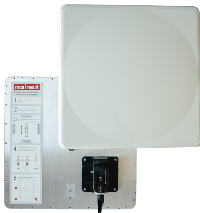
Obrázek 4.3: Anténa pro snímání čipů během závodu [17].
