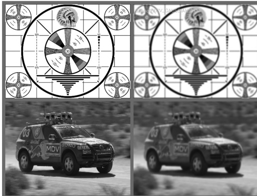
Obrázek 3.10: Ukázka funkce Gaussova filtru pro vyhlazení obrazu. Převzato z [7].
