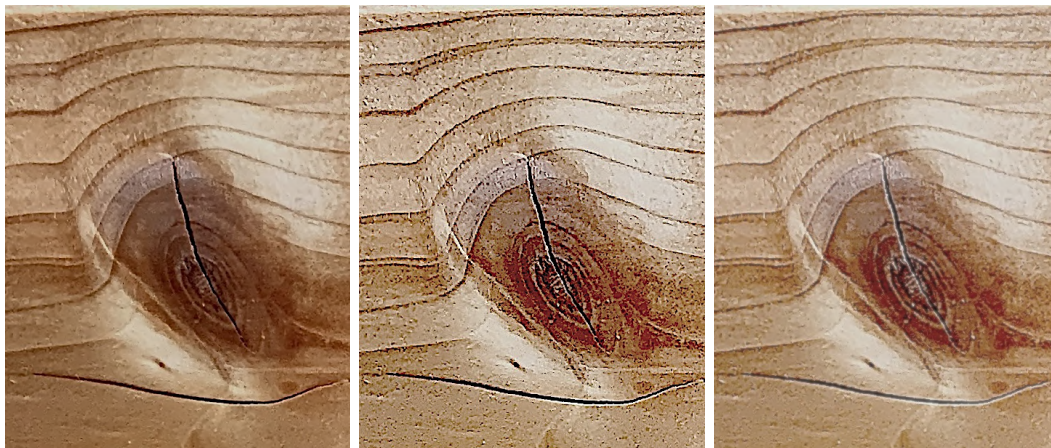
Obrázek 4.4: Snímek průměrovaný ze zaostřené sady snímků metodou Unsharp masking . Vlevo průměrovaný snímek z nezaostřené sady, uprostřed průměrovaný snímek ze zaostřené sady, vpravo průměrovaný snímek ze zaostřené sady s redukcí šumu pomocí Gaussova filtru.
