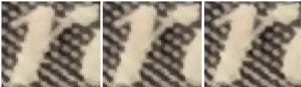
Obrázek 3.11: Porovnání funkce interpolací pro 4\times zvýšení původního rozlišení obrázku. Vlevo původní snímek, uprostřed metoda Nejbližšího souseda, vpravo metoda Lanczosova.
