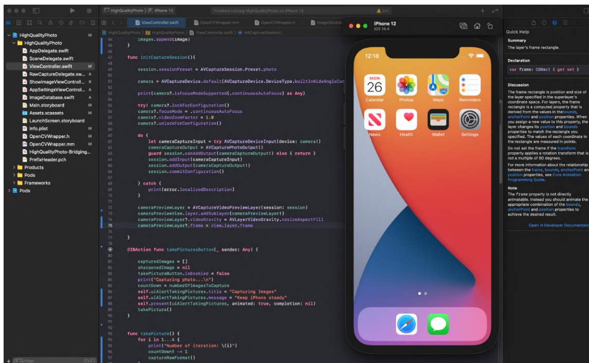
Obrázek 2.1: Ukázka vývojového prostředí Xcode s puštěným simulátorem iOS.
