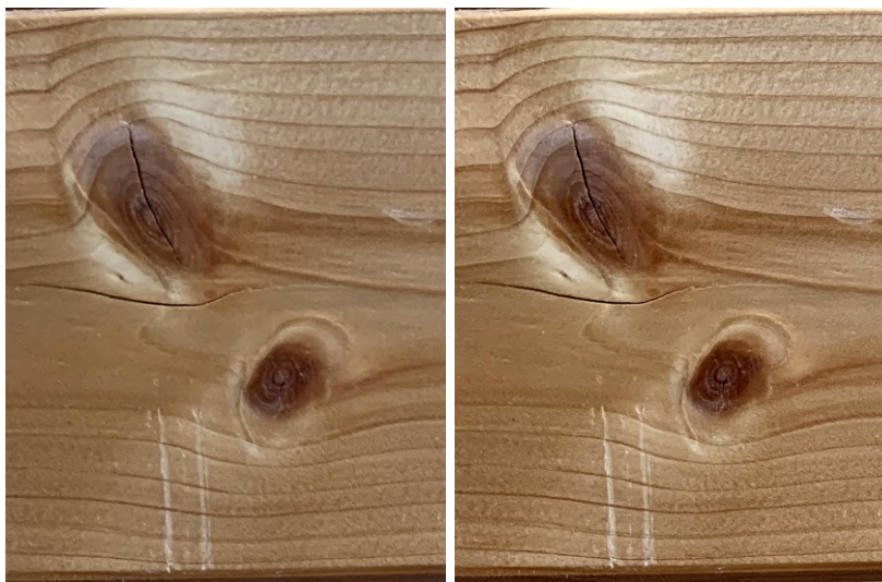
Obrázek 4.1: Ukázka výsledku průměrování ze zarovnané sady snímků. Vlevo první ze sady snímků, vpravo průměrovaný z 10 snímků.
