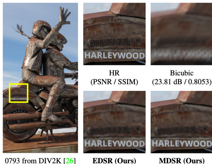
Obrázek 3.1: Ukázka funkce hlubokých neuronových sítí EDSR+ a MDSR+ při porovnání s bikubickou interpolační metodou a originální snímkem ve vysokém rozlišení (obrázek označený HR). Obrázek převzatý z [15].
