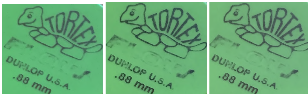
Obrázek 4.5: Porovnání výstupu (uprostřed) sekvence pro zvýšení kvality snímku rovinné plochy s upravenou sekvencí pro mobilní aplikaci (vpravo) s jedním ze snímků z datové sady (vlevo). Vypočítaný snímek má zvýšené rozlišení o 200%, sloučení se provedlo průměrováním.
