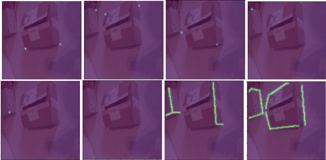
Obr. 5.3: Ukážka ground-truth dát použitých pre tréning. Na obrázku je možné vidieť niekoľko confidence máp vizualizovaných vo forme tepelnej mapy. Každá z nich popisuje pozície iného typu kľúčových bodov.
