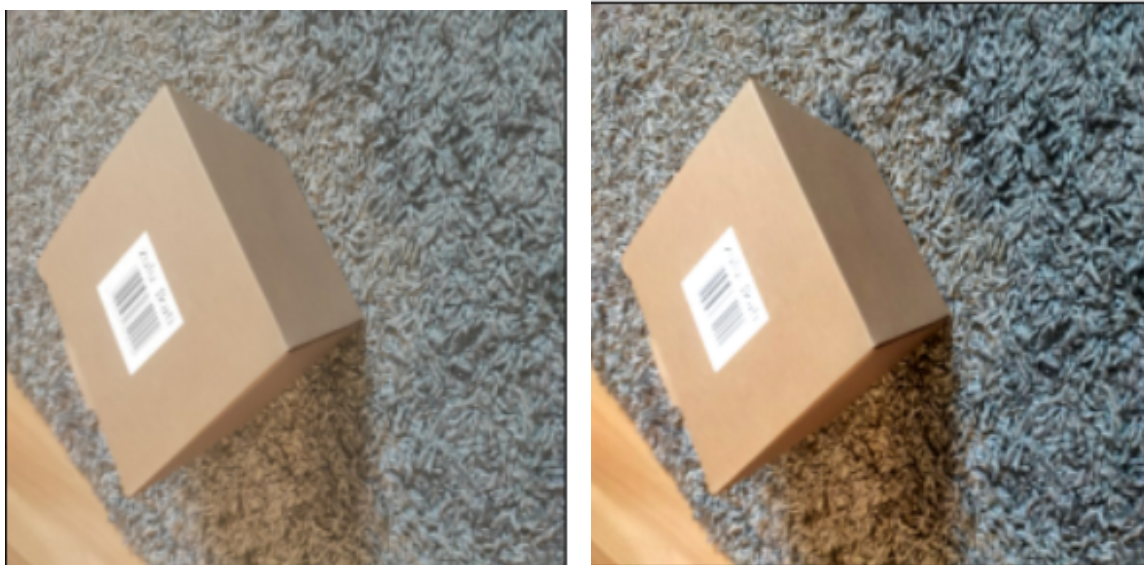
Obr. 5.4: Vľavo vstupný tréningový vstupný obrázok pred augumentáciou, v pravo obrázok po augmentácii. Augmentácia spočíva v náhodnej zmene kontrastu a jasnosti obrázka.
