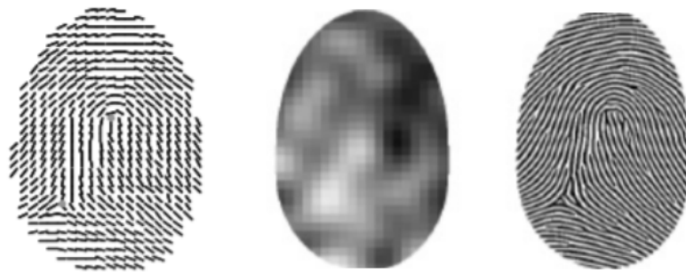
Obr. 4.3: Zobrazené sú výstupy druhého, tretieho a štvrtého kroku algoritmu na generovanie hlavného dokonalého odtlačku prsta. Zľava: pole orientácii, mapa hustoty papilárnych línií, tvar papilárnych línií. Obrázok bol prevzatý a upravený z [9].
