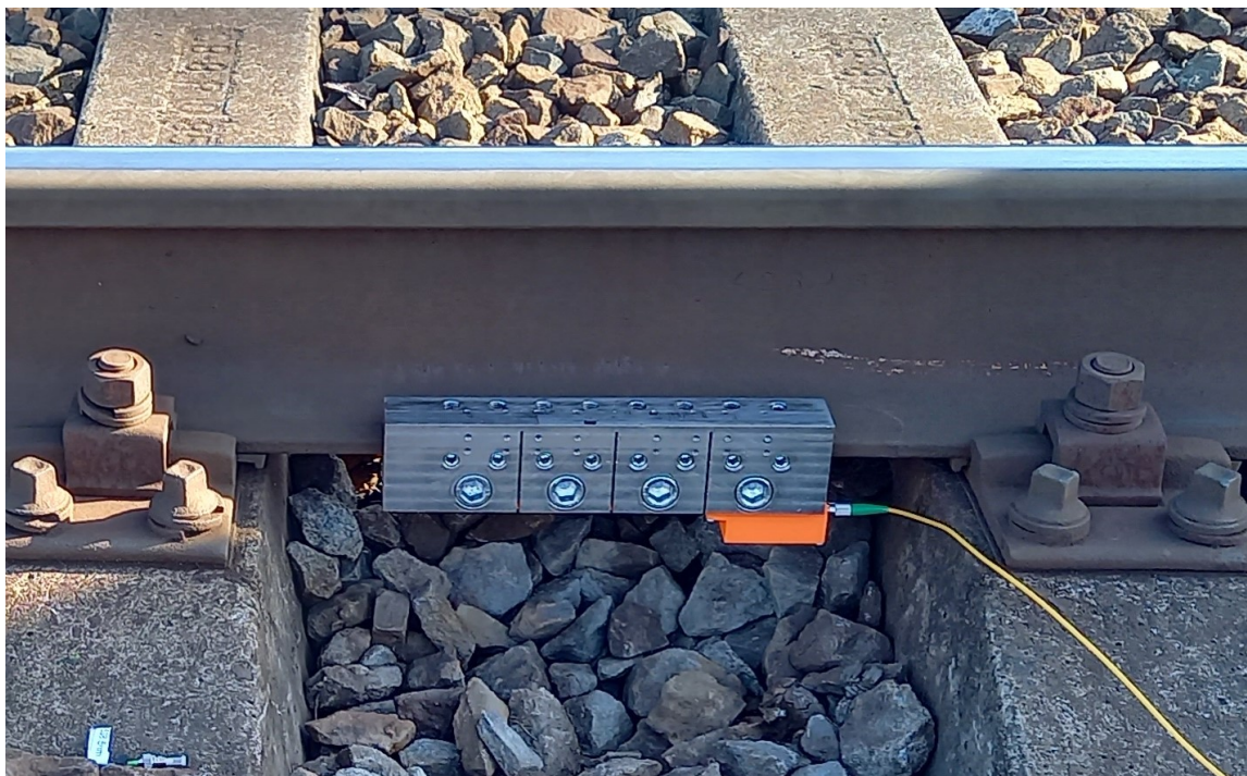
Obrázek 2.3: Umístění senzoru na kolejnici.
