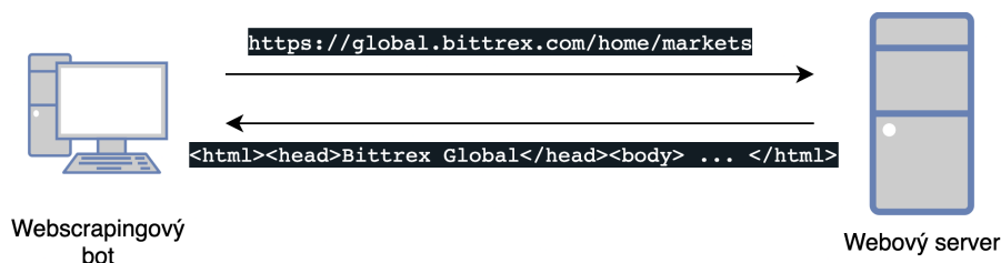
Obrázek 5.2: Průběh získání dat pomocí webscrapingu
