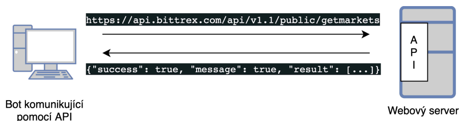
Obrázek 5.1: Získávání dat pomocí API
