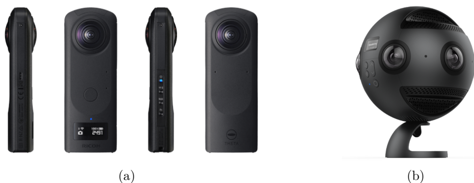
Obrázek 2.4: (a) Kamera Ricoh Theta Z1 10 , která obsahuje 2 kamerové senzory a umožňuje pořídit panoramatickou fotografii v rozlišení 6720x3360 a panoramatické video v rozlišení až 3840x1920 při 29.97fps, (b) Kamera Insta360 Pro 11 umožňující pořízení 360° videa v rozlišení až 7680x3840(8K) při 30fps pomocí 6 kamerových senzorů typu rybího oka.
