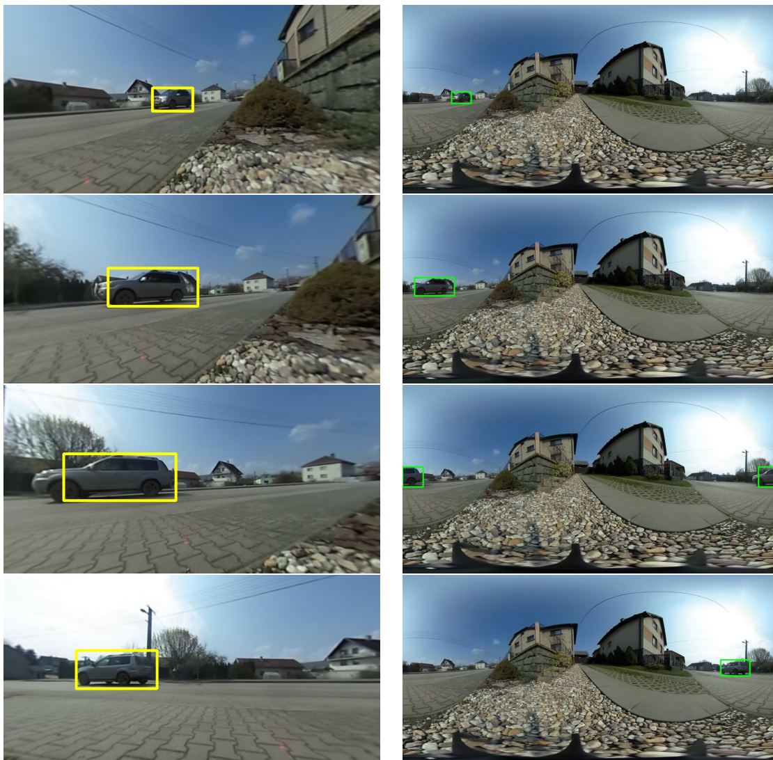
Obrázek 5.8: Demonstrace vylepšení označeného jako NFOV ( Normal Field Of View ), které umožňuje eliminaci radiálního zkreslení. Vlevo jsou rektilineární snímky, ve kterých probíhá samotný proces sledování objektů a vpravo jsou ekvirektangulární snímky načtené přímo z videa, do kterých je predikovaný rámeček zpětně převáděn. Je zřejmé, že na této videosekvenci došlo k situaci, kdy se sledovaný objekt dostal přes okraj originálního snímku. Díky rektilineární projekci se zde však úspěšně podařilo zaměřovat rychle jedoucí vozidlo. Tento proces sledování odpovídá výsledkům upravené implementace trackeru KYS [6].
