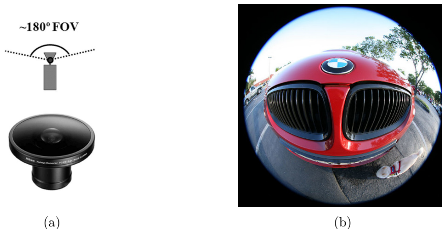
Obrázek 2.3: (a) Čočka typu rybí oko [67] s ilustrací možnosti pořízení přibližně 180^\circ úhlu záběru ( FOV - field of view ), (b) Snímek pořízený objektivem typu rybí oko 8
