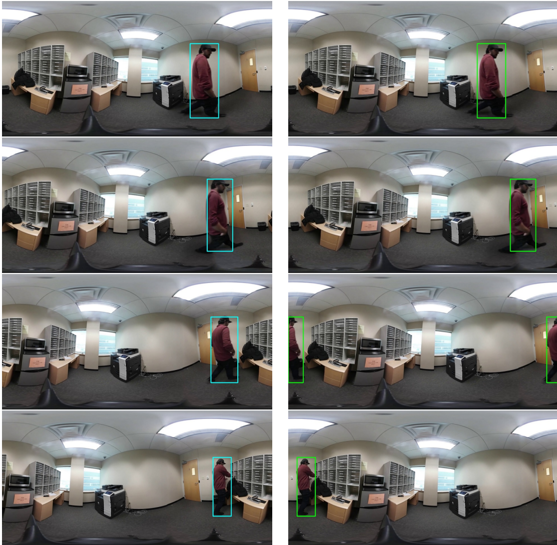
Obrázek 5.5: Demonstrace vylepšení označeného jako BORDER . Vlevo jsou kvadrátové snímky, ve kterých probíhá samotný proces sledování objektů a vpravo jsou kvadrátové snímky načtené přímo z videa. Je zřejmé, že na této videosekvenci došlo k situaci, kdy se sledovaný objekt dostal přes pravý okraj originálního snímku. Nicméně díky simulaci sférické rotace byl tracker schopen sledovaný objekt stále zaměřovat. Tento proces sledování odpovídá výsledkům upravené implementace trackeru Ocean [96].
