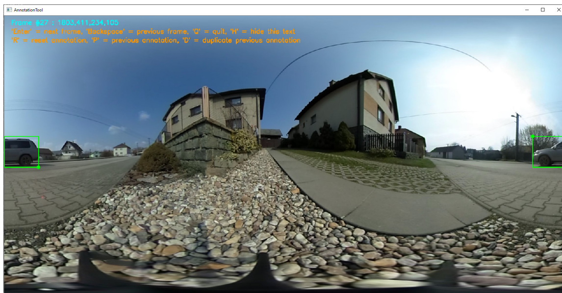
Obrázek 5.9: Ukázka anotace snímku pomocí jednoduchého nástroje, který byl vytvořen za účelem tvorby vlastního datasetu. Tento nástroj je postaven na mouse events a keyboard events , které lze zachytit pomocí knihovny OpenCV .
