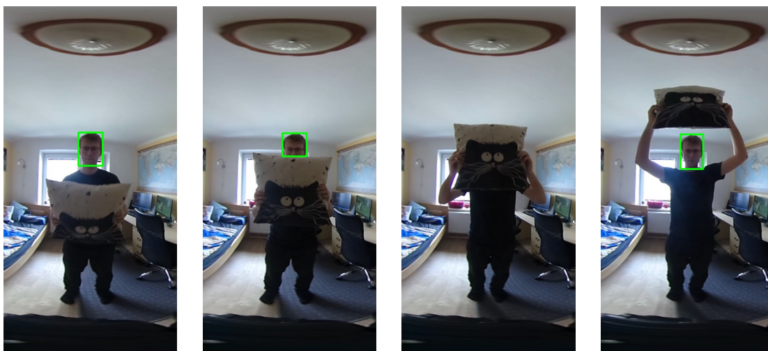
Obrázek 6.11: Sledovaný objekt (lidský obličej) je během této videosekvence několikrát částečně i úplně zakryt. Každý snímek na tomto obrázku odpovídá úhlu záběru 90^\circ \times 180^\circ z původní ekvirektangulární projekce. Ostatní části původní projekce byly oříznuty za účelem zvýraznění sledovaného objektu.
