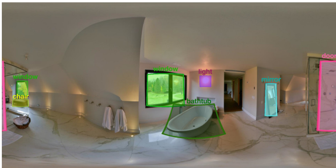
Obrázek 4.8: Příklad anotovaného snímku v ekvirektagulární projekci, který je součástí datasetu 360-Indoor [13] určeného pro strojové učení i vyhodnocení detekce a klasifikace objektů v panoramatických snímcích.
