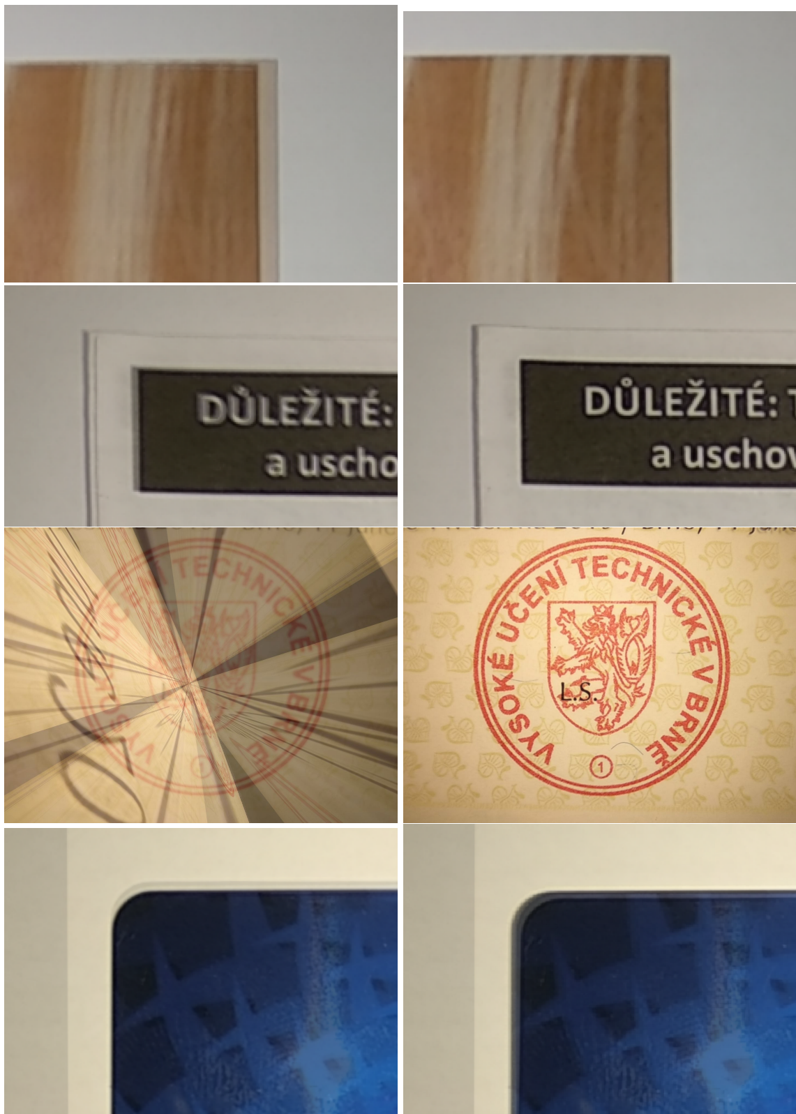
Obr. 5.5: Vystrihnuté časti spojených zarovnaných obrázkov znázorňujúce chybu pri zarovnávaní pomocou ORB (ľavý stĺpec fotiek). SIFT v tomto prípade vykonal správne zarovnanie fotiek (pravý stĺpec). V prípade karty (posledný riadok) nevykonal ani SIFT úplne najlepšie zarovnanie.
