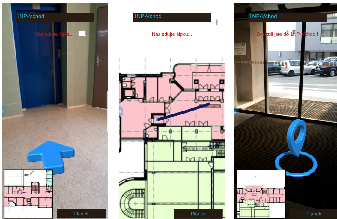
Obrázek 5.4: Vlevo je navigační šipka zobrazená v prostoru před uživatelem navádějící uživatele k cíli. Na prostředním obrázku je modře zvýrazněná cesta mezi uživatelem a hledaným cílem. Vpravo je obrázek s 3D modelem znázorňující cíl cesty.
