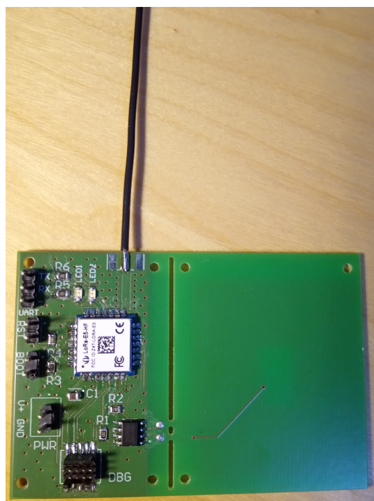
(b) Plošný spoj s vodičem místo antény
