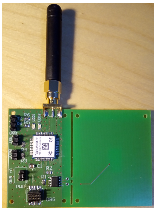
(a) Plošný spoj s SMA konektorem a anténou
