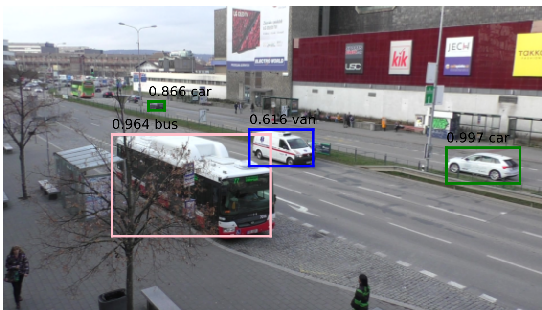
Obrázek 4.12: Vizualizace výstupu detektoru YOLACT++ na testovacím obrázku z lokace Vaňkovka. Bounding box je zobrazen pouze pro detekce s confidence přesahující hodnotu 0,5.
