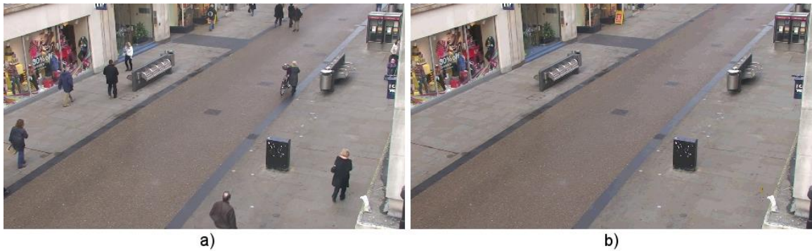
Obrázek 2.4: Pozadí scény zachycené stacionární kamerou. a) Snímek scény s hodně chodci. b) Pozadí scény po analýze scény po dobu několika vteřin. (převzato z [18])
