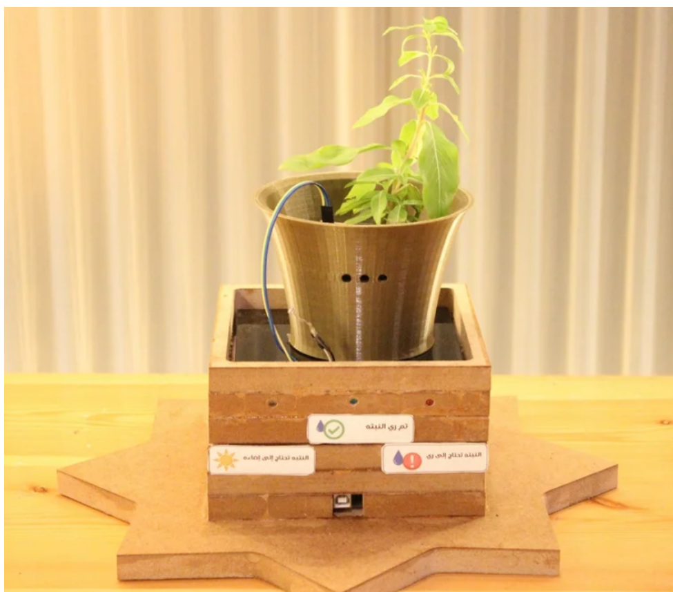
Obrázek 2.4: Chytrý květináč se senzorem vlhkosti napojeným na Arduino. Převzato z https://www.instructables.com/Smart-Garden-1/
