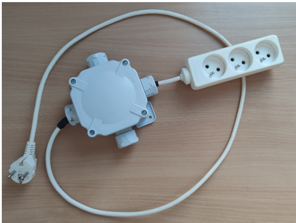
Obrázek 4.2: HW realizace chytré zásuvky.
