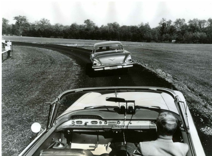
Obrázek 2.2: Zabudovat do silnice ocelový drát, který by sledovaly zabudované magnety v automobilu. Zde vyobrazena „Autonomous Highway System“, jedna z vizí 50. let 20. století. 3
