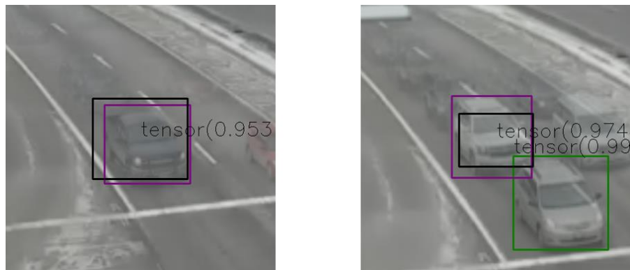
Obrázek 7.2.6: Chybně nahlášená anomálie, protože vozidlo čeká na zelenou příliš dlouho (pozn. ohraničující boxy jsou stejné jako v obrázku 6.3.1 , levý a pravý obrázek jsou z různého videa)
