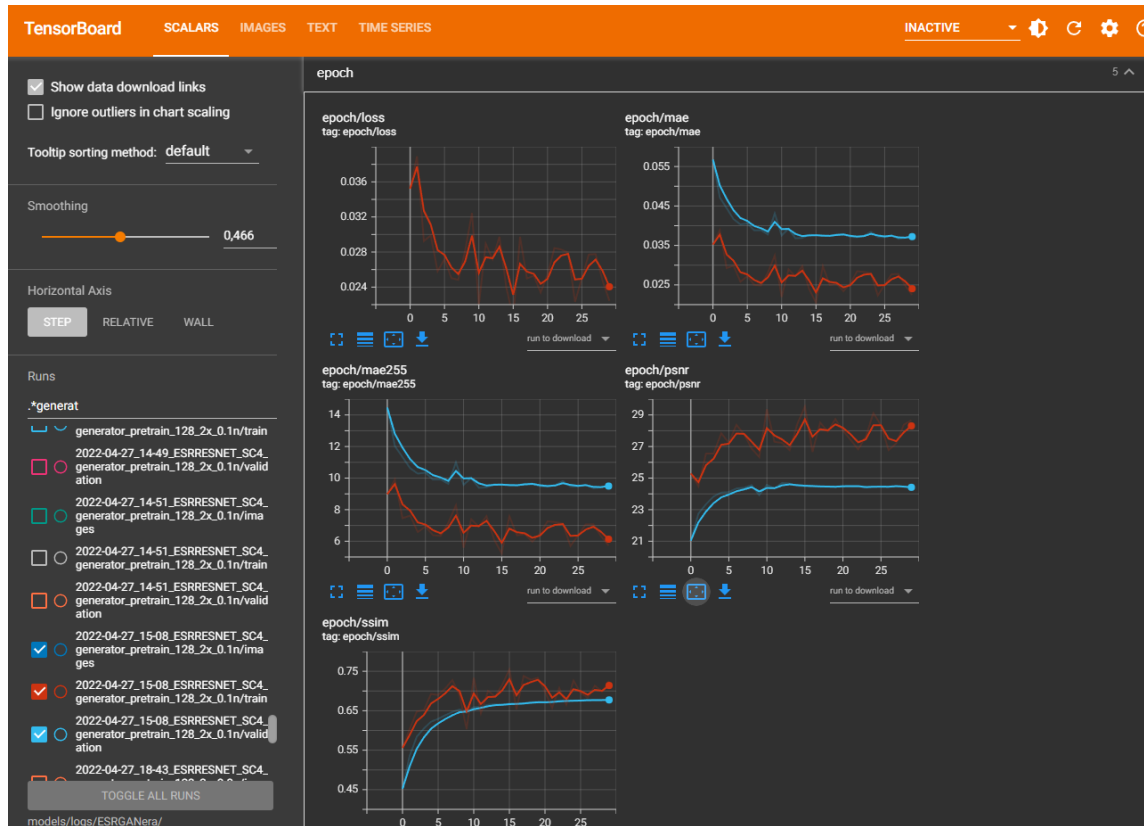
Obr. 6.1: Pokročilé logovanie pomocou TensorBoard. Ide o kartu zobrazujúcu hodnoty chybových funkcií a metrik. Vľavo je možné jednotlivé behy filtrovať pomocou regulárnych výrazov. Na grafoch s dvoma rôznymi farbami čiar ide o výsledok na tréningovej časti oproti validačnej časti dátovej sady v tomto prípade. Tiež je možné porovnávať rôzne behy medzi sebou.
