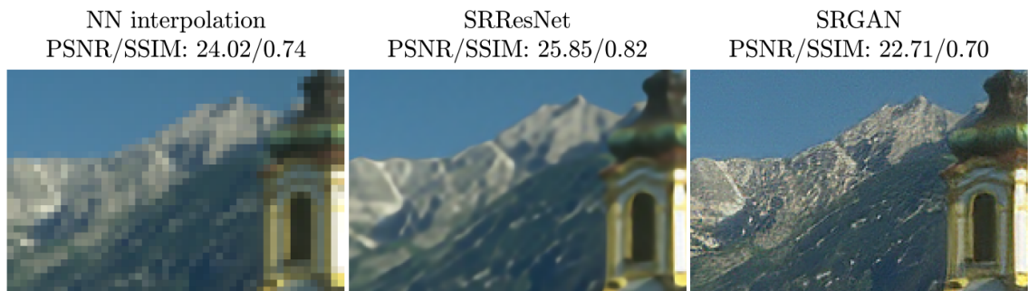
Obr. 3.3: Inkonzistencia hodnôt PSNR a SSIM voči perceptuálnej kvalite obrázka. Vľavo je obrázok, ktorého rozlíšenie bolo zvýšené pomocou jednoduchšej interpolácie algoritmom najbližšieho suseda (spomenutý v časti 3.2). V strede je obrázok, ktorý je výstupom neurónovej siete SRResNet [23], ktorej cieľom bolo dosiahnuť čo najlepšie hodnoty PSNR a SSIM. Nakoniec vpravo je výstup zo siete SRGAN [23], ktorá mala za úlohu maximalizovať perceptuálnu kvalitu obrazu. Hodnoty PSNR a SSIM sú vyššie pri interpolácii metódou najbližšieho suseda ako pri sieti SRGAN, ale vizuálny dojem hovorí presný opak. Obrázok prevzatý z [3].
