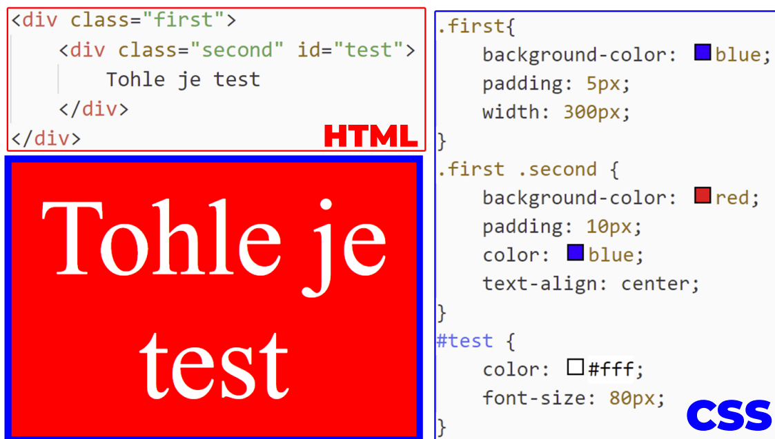
Obrázek 3.6: (Vlevo nahoře) HTML předpis pro prvek vlevo dole, (vpravo) CSS styly pro prvek vlevo dole.
