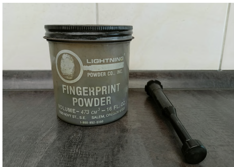
Obrázek 4.1: Magnetický prášek 1-0175 bichromatický a magnetický štětec.
