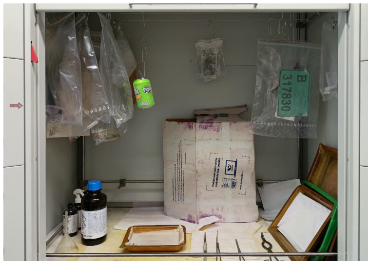
Obrázek 4.2: Dýmová komora pro vyvolávání otisků jodovými parami
