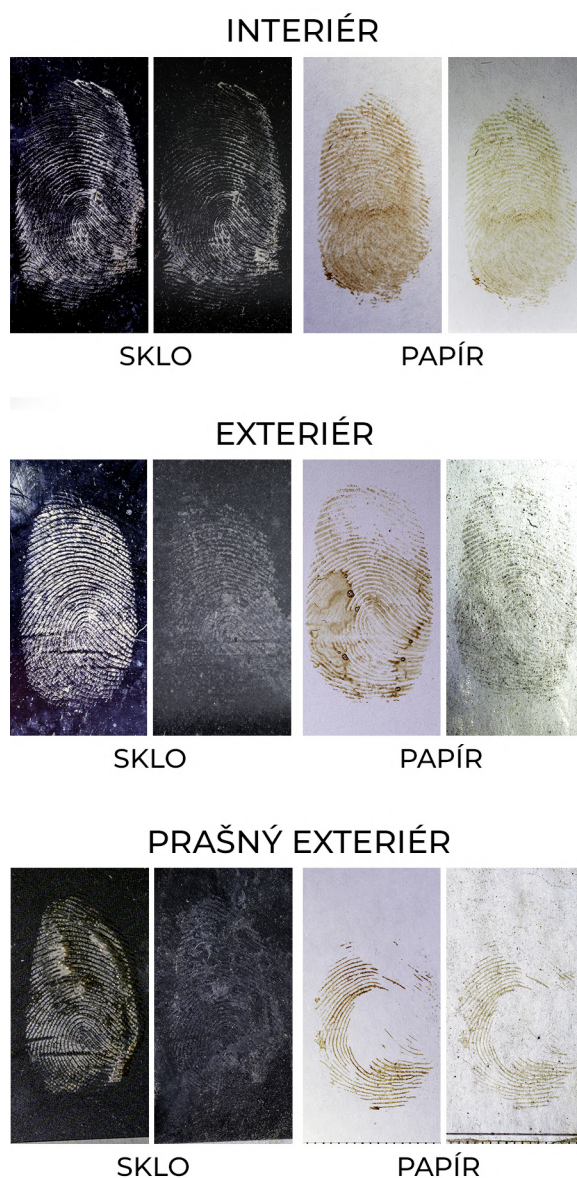
Obrázek 4.9: Porovnání krevních vzorků na neporézním a porézním materiálu.
