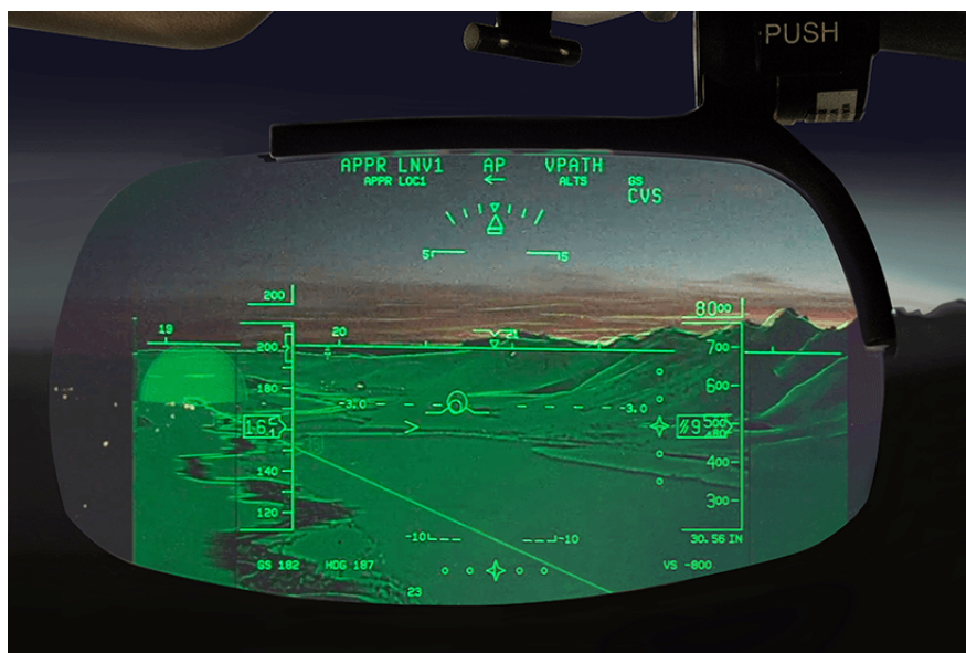
Obr. 2.2: HUD so systémom syntetického videnia. Prevzaté z [34].
