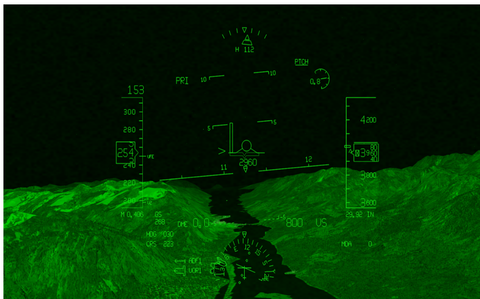
Obr. 3.6: HUD so syntetickým videním. Prevzaté z [17].
