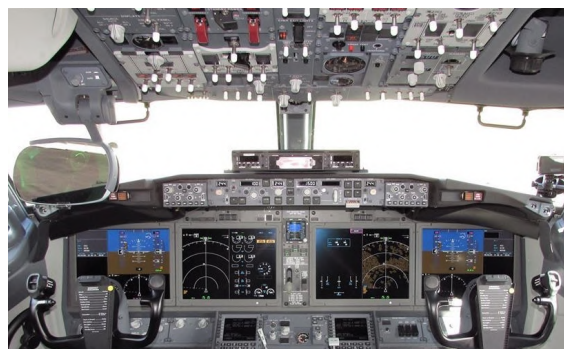
(b) Kokpit letounu dovybavený HUD jednotkou na pozici kapitána. Převzato z [44].
